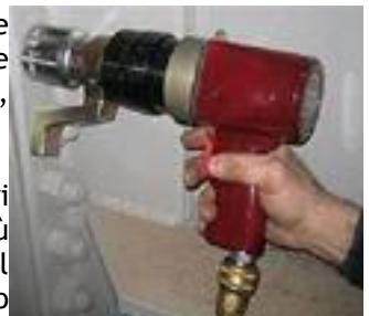
Altra caratteristica che distingue un avvitatore è la possibilità di invertire il senso di rotazione del mandrino per permettere di avvitare e svitare. I modelli più completi sono dotati di un meccanismo a frizione che permette di regolare la forza (o la coppia, per l'esattezza) con cui viene avvitata la vite.
