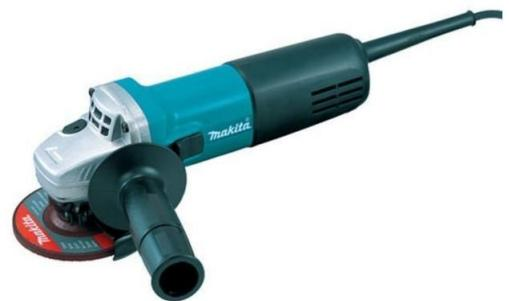
protezione. Occorre tenere presente che i dischi da taglio telati hanno una data di scadenza, è bene accertarsi che non sia superata; nel tempo, le resine impiegate nella mescola abrasiva del disco perdono l'iniziale potere di coesione, con il rischio di rottura durante il taglio.
