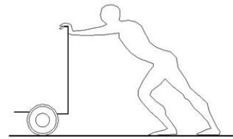
La norma prevede di confrontare i valori di spinta al momento del primo distacco (**sforzo iniziale**) e quello applicato per sostenere il moto (**sforzo di mantenimento**) con omologhi valori da prendere nelle tabelle in allegato alla stessa.
